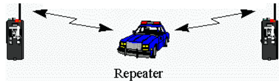
Abbildung 9 Erhöhung der Reichweite durch Repeater-System [23]
